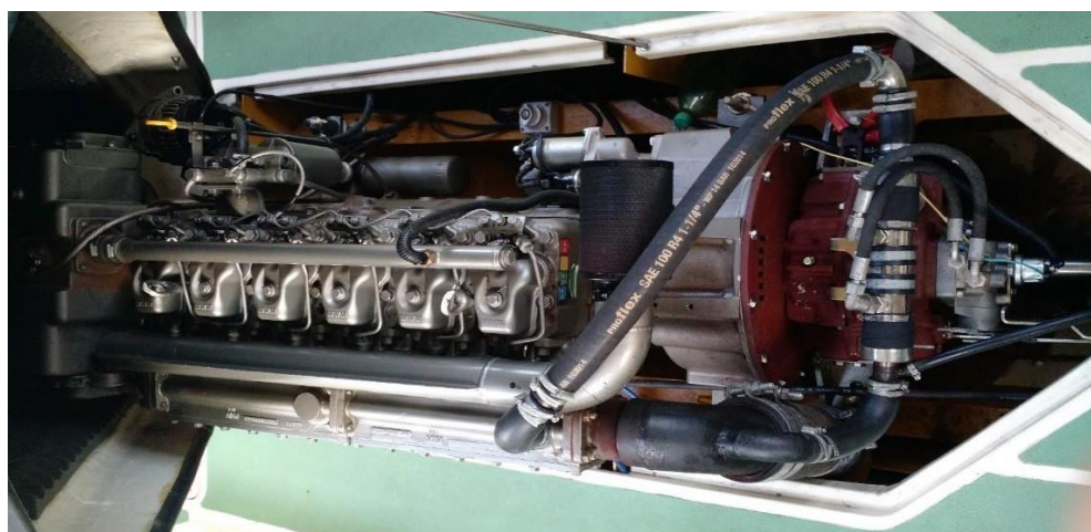
Figura 02- Vista do conjunto motor e transmissão da LE-G
